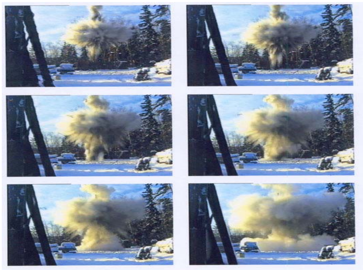
Рис. 3. Вертикальное распыление воды с помощью заряда ПВВ-4 (пластичное взрывчатое вещество)
