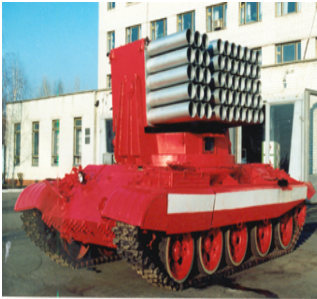
Рис. 1. Технический комплекс типа «Импульс-3м» - самоходная машина на гусеничном ходу
